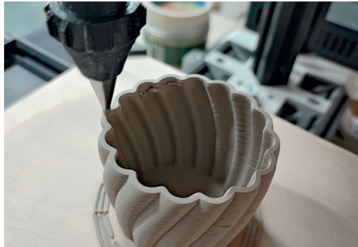
Obr. 10 Průběh tisku testovacího objektu. Tryska 1,2 mm, šířka extruze 2,6 mm, výška vrstvy 1 mm. Foto: Oto Melter
