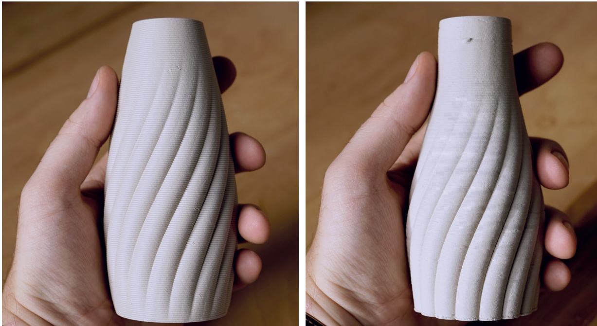
Obr. 8 Pokusná váza typ 1, tryska 1,2 mm, výška vrstvy 1 mm. Obr. 9 Pokusná váza typ 2, tryska 1,2 mm, výška vrstvy 0,5 mm. Foto: Oto Melter
